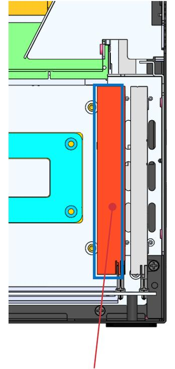
SSD/HDD thickness  $>9.5\text{mm}$  &  $\leq 15\text{mm}$
