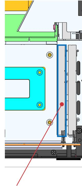
SSD/HDD thickness  $\leq 9.5\text{mm}$
