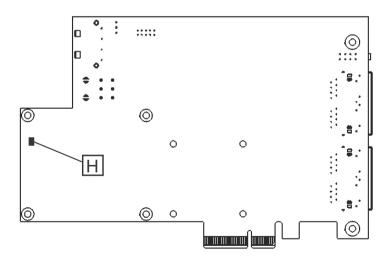
Figure 1-6: PCIe-GIE72/PCIe-GIE72 PRO PCB Underside Layout
