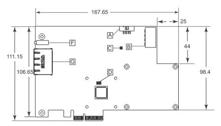
Figure 1-5: PCIe-GIE72/PCIe-GIE72 PRO PCB Top Layout
