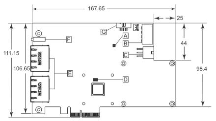
Figure 1-1: PCle-GIE74/PCle-GIE74 PRO PCB Top Layout
